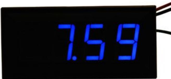
Voltmetro digitale da pannello a 3 cifre 1/2, con display a 7 segmenti blu e in grado di misurare tensioni continue da 0 a 200 V. Alimentazione: da 7 a 30 Vdc.
