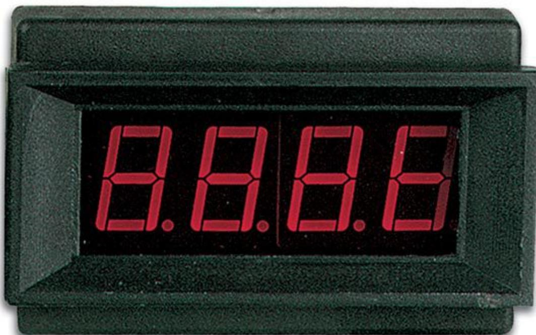
Voltmetro digitale a LED rossi da pannello a 3 cifre 1/2. Mediante l'utilizzo di circuiti dedicati esterni può essere utilizzato come termometro, misuratore di PH, luxmetro, Wattmetro, capacimetro, ecc. Utilizzando un partitore resistivo è possibile misurare una tensione massima di 500 V. Alimentazione 9 Vdc.
