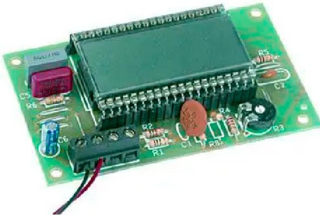
Semplice ed economico voltmetro a cristalli liquidi con display a 3 ½ digit. Può funzionare da 5 a 9 volt con un assorbimento di appena 2 mA: dispone di tre scale di lettura per misure da 200 mV a 200 V. Il modulo può essere utilizzato anche come amperometro e per la misura di tensioni alternate. La gestione del display e l'elaborazione delle misure è affidata ad un solo integrato, un ICL7106 a 40 pin. La scatola di montaggio comprende tutti i componenti, il display LCD e l'integrato ICL7106.
