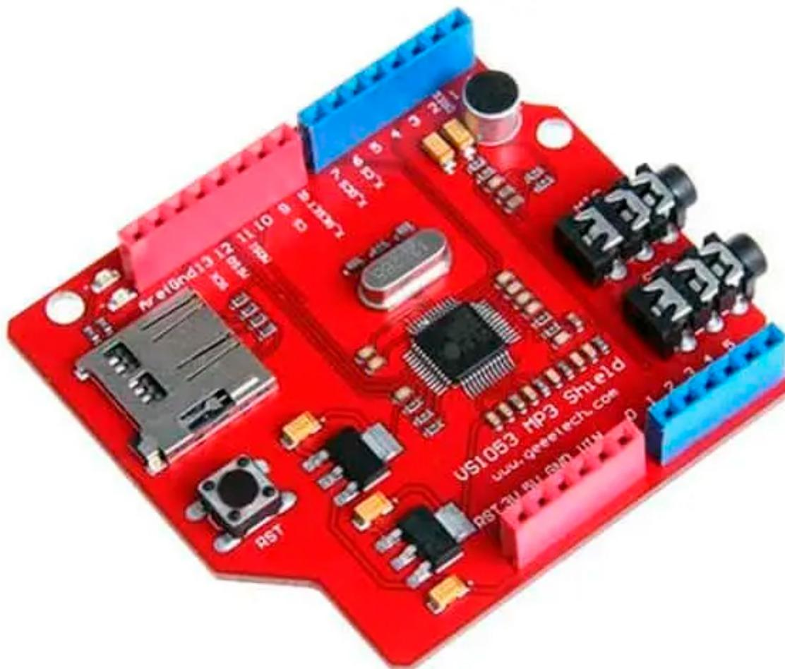
Shield per Arduino basata sul chip di decodifica audio Ogg Vorbis/MP3/AAC/WMA/MIDI VS1053. Permette di leggere e riprodurre i file MP3 contenuti in una SD card inserita nell'apposito slot. Dispone di microfono e ingresso per la registrazione dell'audio su scheda SD, presa jack stereo da 3,5 mm per l'uscita audio (può pilotare cuffie con 30 ohm di impedenza) e pulsante di reset.
