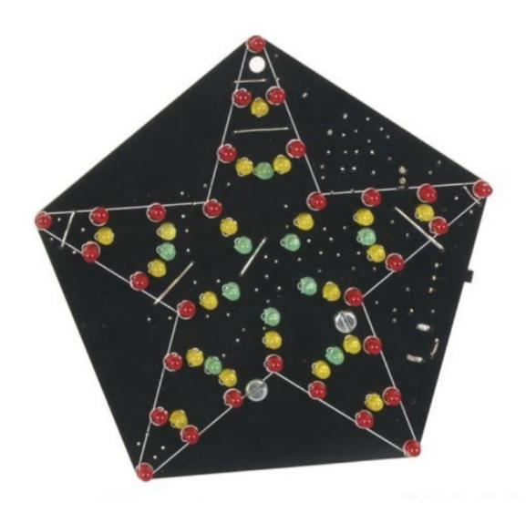
Bellissimo VU-meter a forma di stella. Dispone di 60 LED colorati che si attivano a tempo di musica mediante microfono incorporato. Sensibilità regolabile. Ideale per la realizzazione di gadget luminosi, per feste e per attirare l'attenzione.
