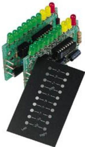
VU-meter con due scale luminose composte da 10 LED (ciascuna), completo di ingresso segnale regolabile. Funzionamento in modo "dot" o "bar". Fornito con pannello frontale adatto per montaggio orizzontale o verticale.
