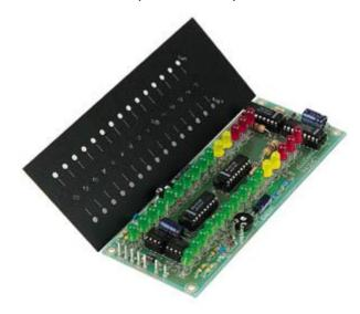
VU-meter stereo di precisione, con indicatore formato da due file di 15 LED. Funzionamento visualizzatore in modo "bar" o "spot". Può essere impiegato per il mixer audio Velleman.
