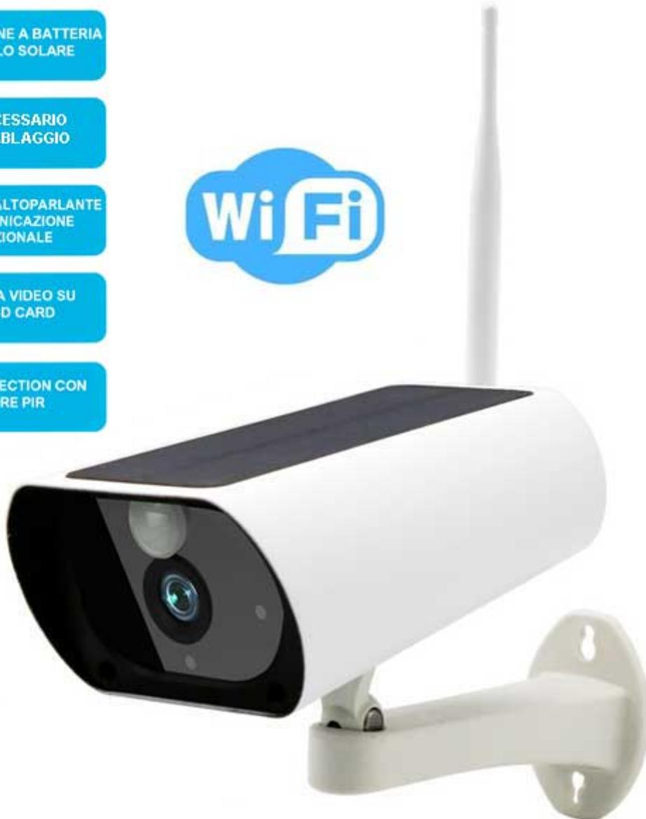
Telecamera da esterno da 2 Megapixel con modulo Wi-Fi, alimentazione a batteria, pannello solare, sensore di movimento PIR, sensore crepuscolare, illuminatore con LED IR a 850 nm con 10 metri di portata, slot per memoria SD Card (max. 64GB), antenna esterna, microfono e altoparlante; il tutto racchiuso in un contenitore realizzato in lega di alluminio pressofuso, antiusura e antigraffio con grado di protezione IP67.
