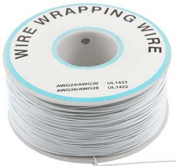
Rocchetto filo di rame stagnato rivestito in PVC di colore bianco AWG30. Sezione (mm): 0,5x0,25, lunghezza: circa 305 metri, dimensioni rocchetto (mm): 70x33 (diametro x altezza), peso: 153 grammi. Ideale per Wire Wrapping Wire.
