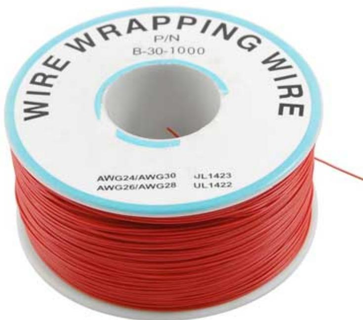
Rocchetto filo di rame stagnato rivestito in PVC di colore rosso AWG30. Sezione (mm): 0,5x0,25, lunghezza: circa 305 metri, dimensioni rocchetto (mm): 70x33 (diametro x altezza), peso: 153 grammi. Ideale per Wire Wrapping Wire.
