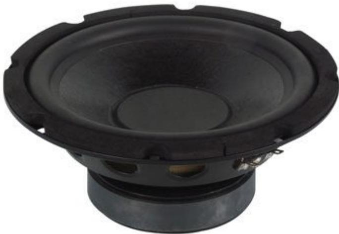
woofer 8" - potenza massima 350 W - impedenza 8 ohm - sospensione in gomma - frequenza di risonanza: da 40 Hz a 6 kHz, sensibilità: 91dB, peso del magnete: 680g, cono: PP. Dimensioni (mm): Ø210x95, interasse fori (mm): Ø200.
