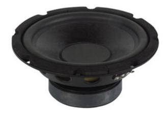
woofer: 6,5", sospensione in gomma, potenza massima: 250 Watt, impedenza: 8 ohm, risonanza: 50-7k, sensibilità: 90dB, peso del magnete: 567 g, cono: PP.
