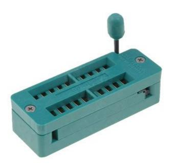
Zoccolo ZIF a 20 pin con forza di inserzione nulla. Dotato di leva per bloccaggio circuiti integrati e terminali ad elevata conduttività. Permette di evitare di piegare o rompere i piedini dei chip. Particolarmente indicato per l'utilizzo con programmatori di microcontrollori.
