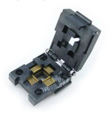
Zoccolo ZIF per integrati SMD QFP con 44 pin. Dotato di leva per bloccaggio circuiti integrati e terminali ad elevata conduttività. Permette la programmazione del chip senza doverlo saldare.
