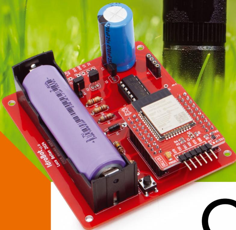
Realizziamo una centralina di irrigazione low-power, alimentata a batteria e programmabile con smartphone tramite Bluetooth Low Energy
